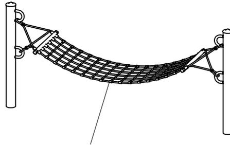
**Achtung: Hängematte erst nach Abbinden der Betonfundamente einbauen!**
